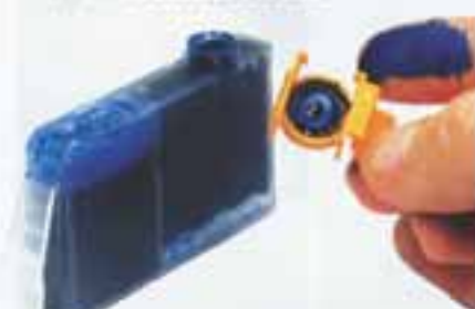
Tropfende Patrone bei Abnahme der Verschlusskappe
